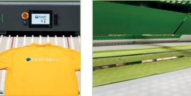
A(s) dobra(s) primária(s) é/são feita(s) por um fluxo de ar pulsado. Antes de ter sido realizada por completo a primeira dobra, mede-se o comprimento. É na base deste comprimento que se pode selecionar um dos muitos possíveis padrões de dobragem. Os modelos de dobragem são automaticamente postos na posição correta e os bicos de pulverização de ar pulsado dobram a peça firmemente à volta dos modelos. A longa dobra primária pode dobrar peças de até 2400 mm.
