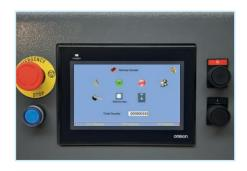
A **T.towel** tem um sistema de controlo baseado em PLC. A máquina é operada através de um ecrã tátil a cores de 7". O sistema de controlo necessita de um alto poder de computação, por isso a TEXFINITY optou pela OMRON.
